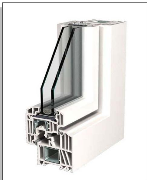
pluricamere. La configurazione dei profili è tale da permettere la raccolta di eventuale acqua di infiltrazione nell'apposita vasca e di eliminarla attraverso appositi fori di drenaggio posti sulla camera esterna. La sezione del telaio è di 70 mm, mentre la parte per il battente è di 80 mm. Tutti i profili sono rinforzati con un'anima in acciaio zincato appositamente sagomata e alloggiata nell'apposita camera. Come sistema di oscuramento sono previste
